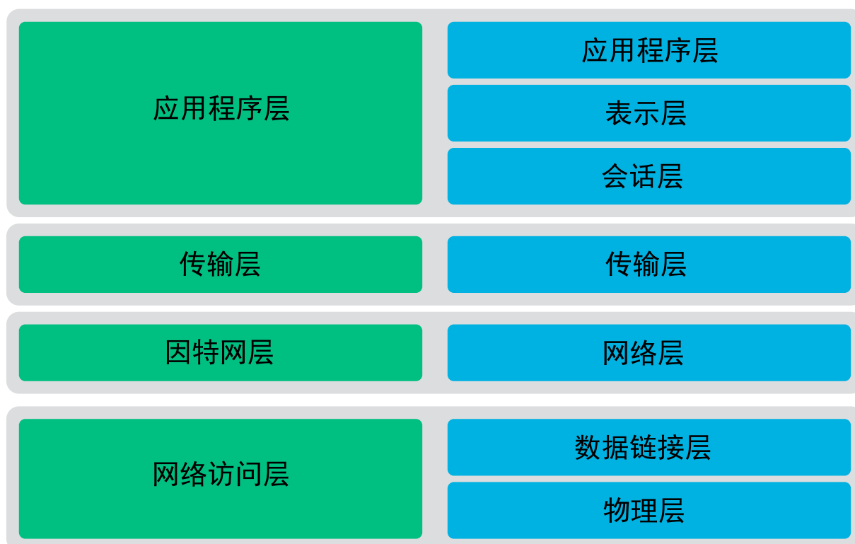
图 16.1 TCP/IP 的简化层次模型
